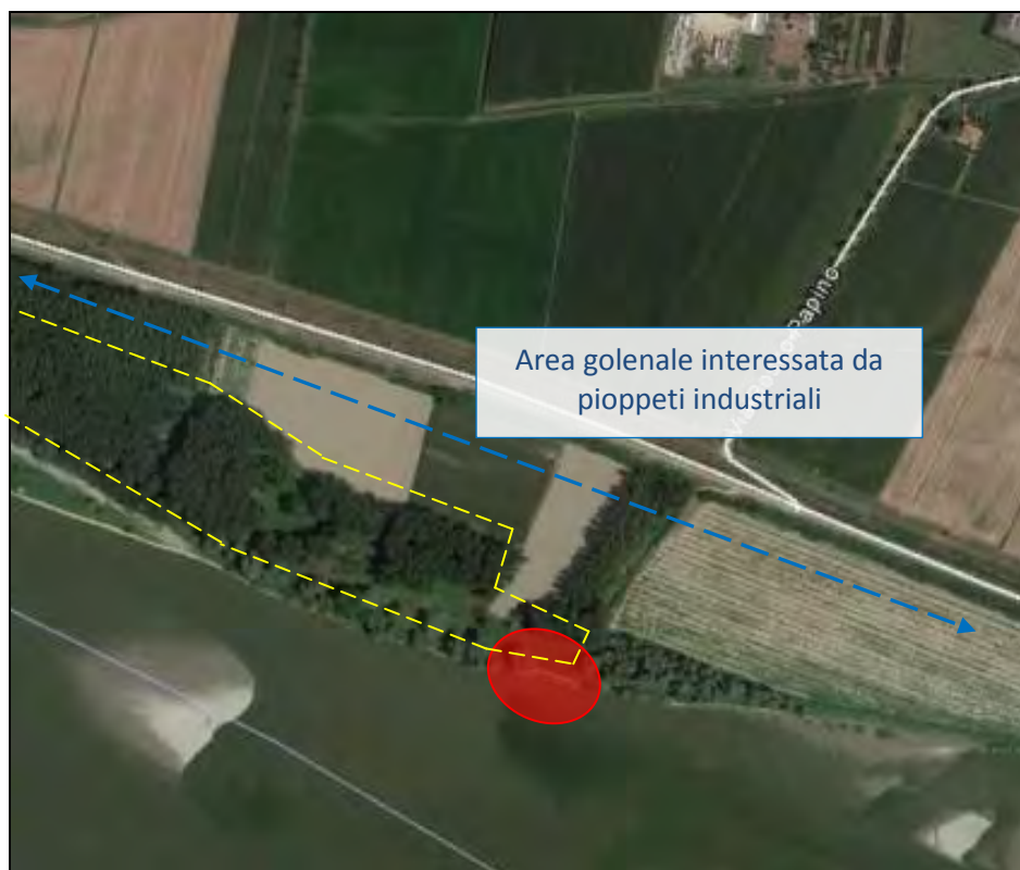
Figura 2 - Vista complessiva dell'area golenale– in rosso è evidenziata l'area interessata dalla realizzazione della difesa di sponda e del repellente - con linea tratteggiata gialla è evidenziato il perimetro del locale bosco ceduo
